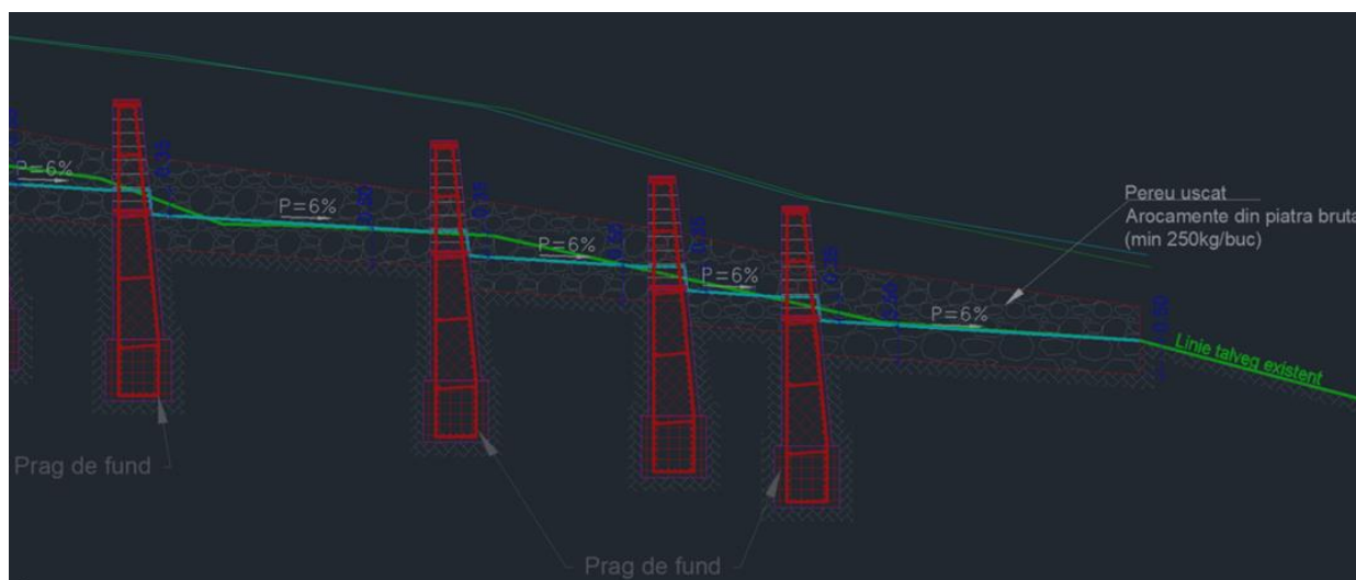
Figură 30 - Amenajare torent- Secțiune în lungul albiei
